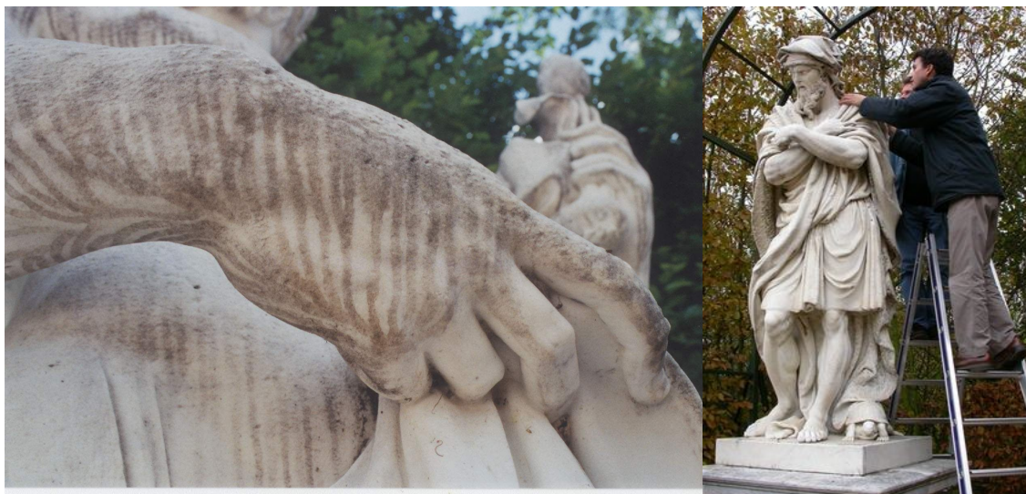
Altération microbiologique du marbre et prélèvements sur la statuaire en marbre du parc de Versailles
